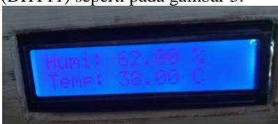
Gambar 5. Tampilan Pada LCD 16x2
